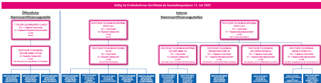
Abbildung 1: Übersicht des Root- und Sub-CAs ab Zertifikatsausstellungsdatum 14.07.2020
